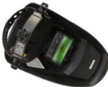
Маска сварочная **ELAND X801** с автоматическим светофильтром предназначена для защиты глаз и лица сварщика от излучения сварочной дуги и брызг расплавленного металла. Светофильтр автоматически затемняется при зажигании сварочной дуги и автоматически возвращается в исходное состояние (прозрачно) после окончания сварки. Исходное затемнение составляет 4DIN.
